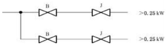
G.2.3 不带风机或有预清扫的采暖炉燃气通路由不同步关闭的两道阀组成的最低要求。
