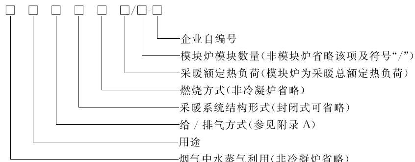
示例 1：采暖额定热负荷为 24 kW 的全预混燃烧封闭式 1G 型两用型冷凝炉表示为：LL1GBQ24-×××或 LL1GQ24-×××。
