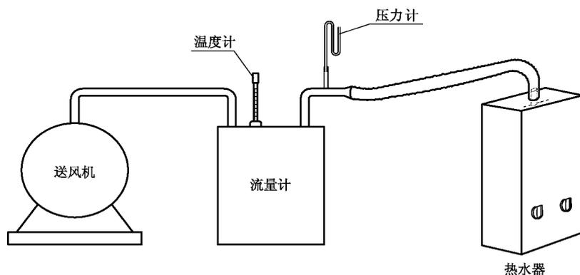
图 24 密封结构漏气试验装置
