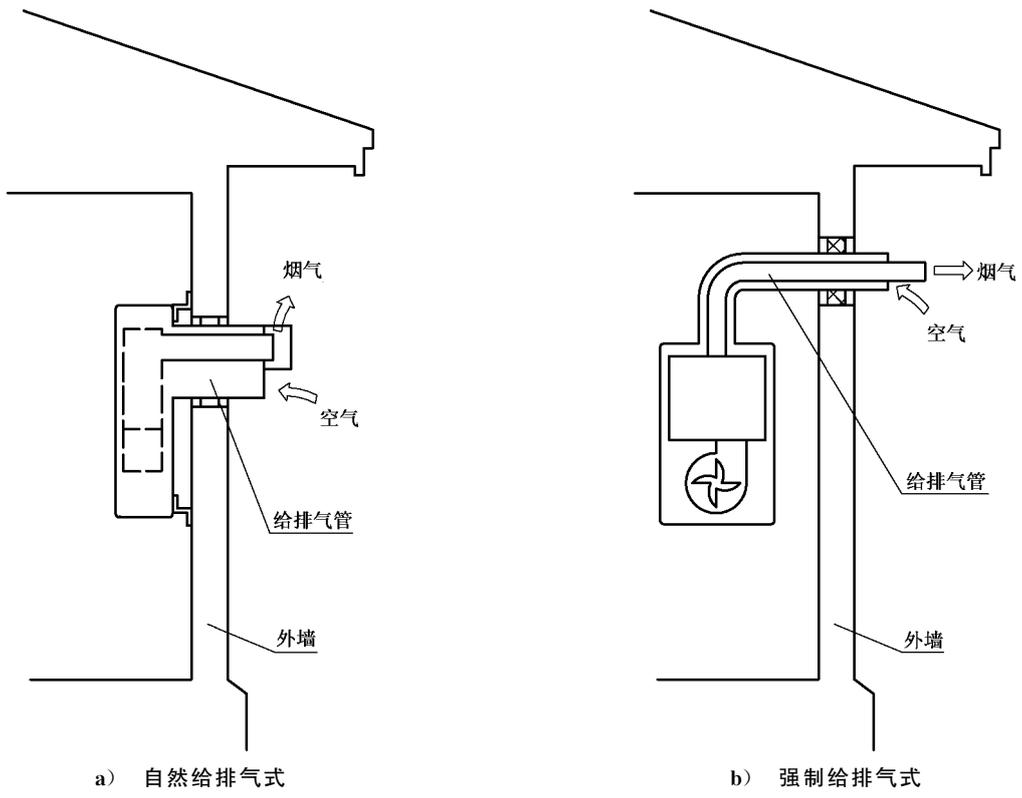
图3 室内型自然给排气式、强制给排气式
