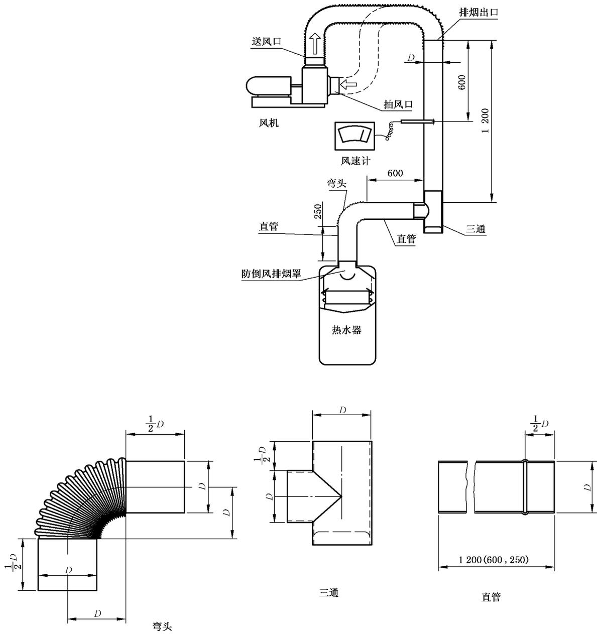
图 15 自然排气式热水器试验装置示意图
